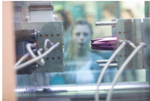
BU: Becher aus dem Kunststoff Makrolon im geöffneten Spritzgießwerkzeug.
